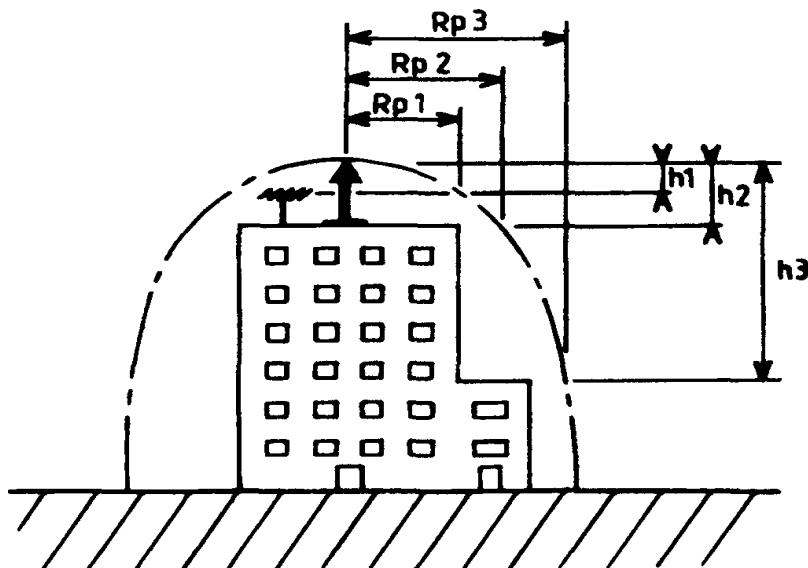
$h_1, h_2, h_3$  е височината на върха на мълниеприемника с изпреварващо действие по отношение на хоризонтална повърхност, преминаваща през върха на защитавания обект;
