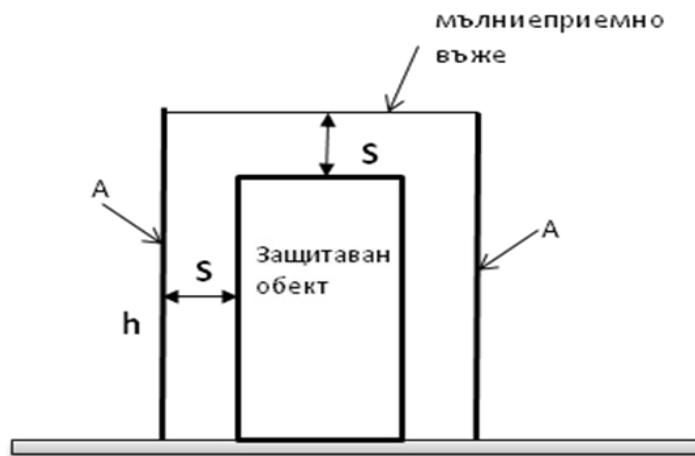
$A$  са опорите (мачтите) на мълниеприемния проводник (въже);
