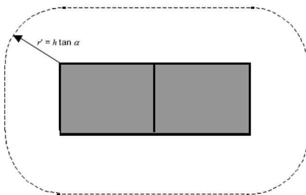
*Фиг. 27.* Защитна зона на прилежащо пространство, определяна по метода на мълниезащитния ъгъл, при мълниеприемна мрежа
