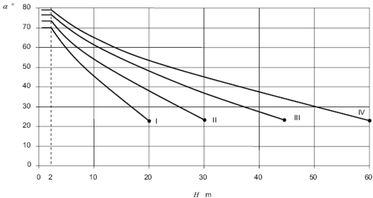
*Фиг. 18. Стойности на мълниезашитния ъгъл  $\alpha$  в зависимост от нивото на мълниезашита и отстоянието  $H$  на върха на мълниеприемника от защитаваната хоризонтална повърхност*
