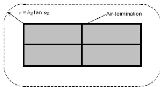
*Фиг. 26.* Защитна зона на прилежащо пространство, определяна по метода на фиктивната търкаляща се сфера, при мълниеприемна мрежа
