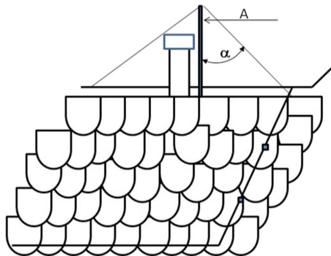
A е прътов мълниеприемник за защита на надпокривно съоръжение, проектиран по метода на мълниезащитния ъгъл;
