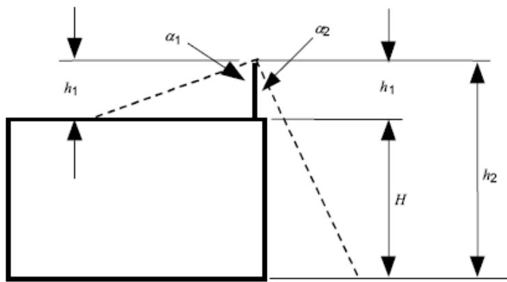
Фиг. 20. Мълниезащитна зона на вертикален прътов мълниеприемник
